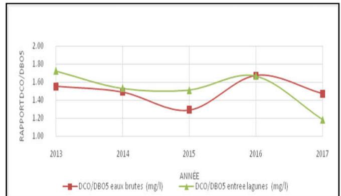
Figure 5. Rapport DCO/DBO<sub>5</sub> à l'entrée de la STEP et des lagunes de 2013 -2017
